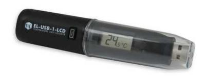
デジタル温度表示付きの EL-USB-1LCD は、最大 16,382 の測定データをメモリーすることができる温度データロガーです。本体は完全 防水構造 IP67 (水深 1m の場所に 30 分浸漬可能)なため、屋外での使用に対応可能です。
