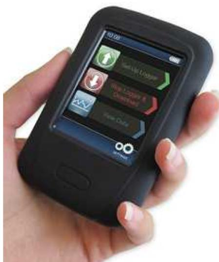
EL-DataPad を使用した場合、パソコンがなくても EL-USB ロガーのプログラムや測定データのダウンロードがおこなえますので、現場での使用に最適です。ダウンロードデータはグラフと要約を表示できます。
