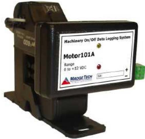
データロガーMotor101A は 200 アンペアまでのモーターや機械の On/Off 状態を記録する新しいデータロガーシステムです。Motor101A は電流スイッチが付属しており、モーターや機械の電流値が予め設定されている 150 mA を超過又は下回ったときに On/Off 状態を自動記録します。
