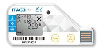
ITAG®4 TH データロガーは、医薬品・ワクチン・血液製剤・各種食品や精密電子部品・電子部品材料等の保管並びに輸送温湿度の変動を監視するために開発されました。TempSen の高度な測定技術により、皆様は、信頼性の高い監視結果を簡単に得ることができます。
