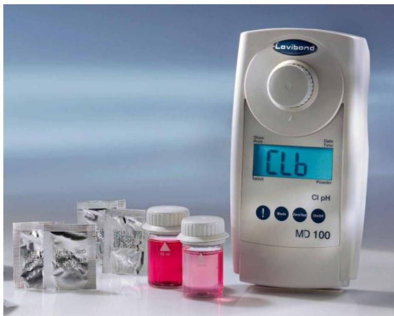
MD100 シリーズは予め、各種水質成分を分析するためのパラメータが内蔵されている分光光度計で、資料溶液に試薬を加えて発色させ溶液の吸光度を測定して目的の成分濃度を測定します。そのため、使用が簡単で精度の高い水質測定がおこなえます。MD100シリーズは単項目用と複合用の2タイプがあります。
