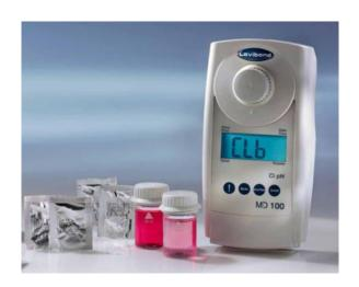
MD100-LT は最高10 mg/ICl2 までの高い濃度の残留塩素測定を可能です。DPD1 試薬とDPD3試薬を使用することで、遊離残留塩素のみならず全残留塩素の測定がおこなえ、全残留塩素と遊離残留塩素の差から結合塩素濃度を判定することができます。
