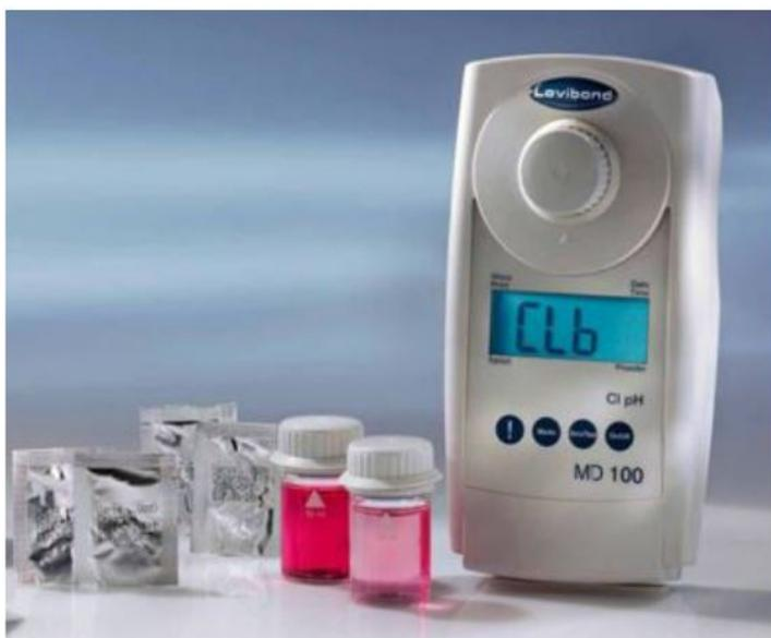
MD100-UHは5~200 mg/l Cl<sub>2</sub>までの高濃度有効塩素を測定できる塩素濃度計です。試薬はヨウ化カリウム/酸添加法を採用していますので、安心してご使用いただけます。
