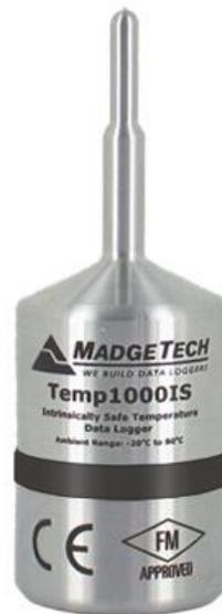
Temp1000IS は防爆型の高精度温度データロガーです。本体は本質安全規格 Class I, II, III, Division 1, Groups A-G,  $-40^{\circ}\text{C} < \text{Tamb} < +80^{\circ}\text{C}$ , T4A 並びに危険な環境での非引火性規格 Class I, II, III, Division 2, Groups A-D, F, G,  $-40^{\circ}\text{C} < \text{Tamb} < +80^{\circ}\text{C}$ , T4A, Temperature Class: T4A 適合品です。Temp 1000IS はエチレンオキサイドガス滅菌温度管理や危険な環境での温度管理に使用できます。
