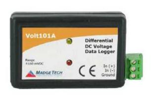
低価格の Volt101A は最先端の技術を有する直流電圧データロガーです。高い精度および16ビットの分解能により、低レベル直流電圧を高精度で記録することができます。
