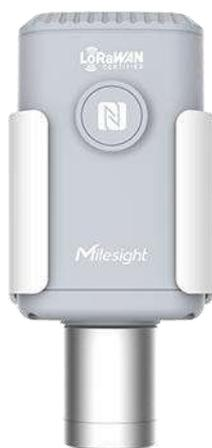
EM500-CO2 は、過酷な環境で CO2、温度、湿度、気圧を測定し、LoRaWAN® テクノロジーを使用してデータを送信するために設計されています。低消費電力テクノロジーにより、EM500-CO2 は 19000 mAh バッテリーで最大 10 年間動作します。Milesight LoRaWAN® ゲートウェイと Milesight IoT Cloud ソリューションを組み合わせることで、ユーザーはすべてのデバイス データをリモートで視覚的に管理できます。EM500-CO2 は、スマート農業、スマートシティ、森林火災検出などのアプリケーションに広く使用されています。
