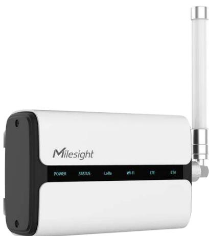
UG65 は、堅牢な 8 チャンネルの屋内 LoRaWAN® ゲートウェイです。SX1302 LoRa チップと高性能クアッドコア CPUを採用したUG65 は、2,000 を超えるノードとの接続をサポートします。UG65 は最大 15 km の見通し距離を持ち、都市環境で約 2 km をカバーできるため、スマートオフィス、スマートビルディング、その他多くの屋内アプリケーションに最適です。
