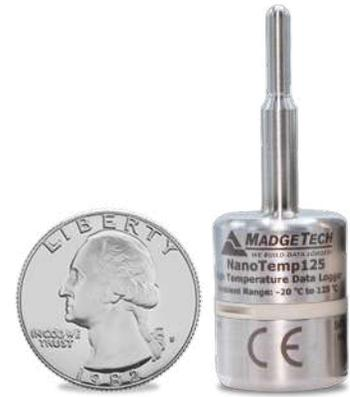
NanoTemp125 は、最も厳しい環境向けに設計された、高精度の温度データロガーです。狭いスペースに最適なサイズのこの耐久性のあるステンレススチール製ロガーは、耐圧防水構造、-20 °C から +125 °C の温度範囲で動作します。NanoTemp125 では精度が最優先であり、±0.1 °C の精度でデータの信頼性が常に確保されます。
